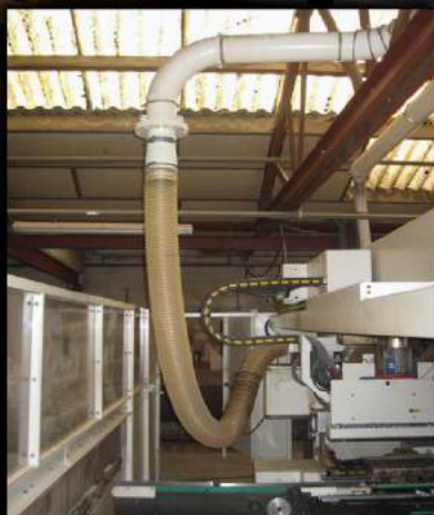
Raccord tournant Évite les torsions des flexibles et améliore leur longévité.
