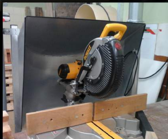
Capot sur-mesure pour aspirer les poussières de coupes émises par la scie radiale.
