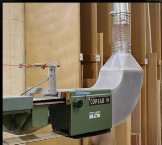
Cape de ponceuse longue bande avec buses de nettoyage de la bande abrasive par air comprimé. En partenariat avec la CARSAT.
